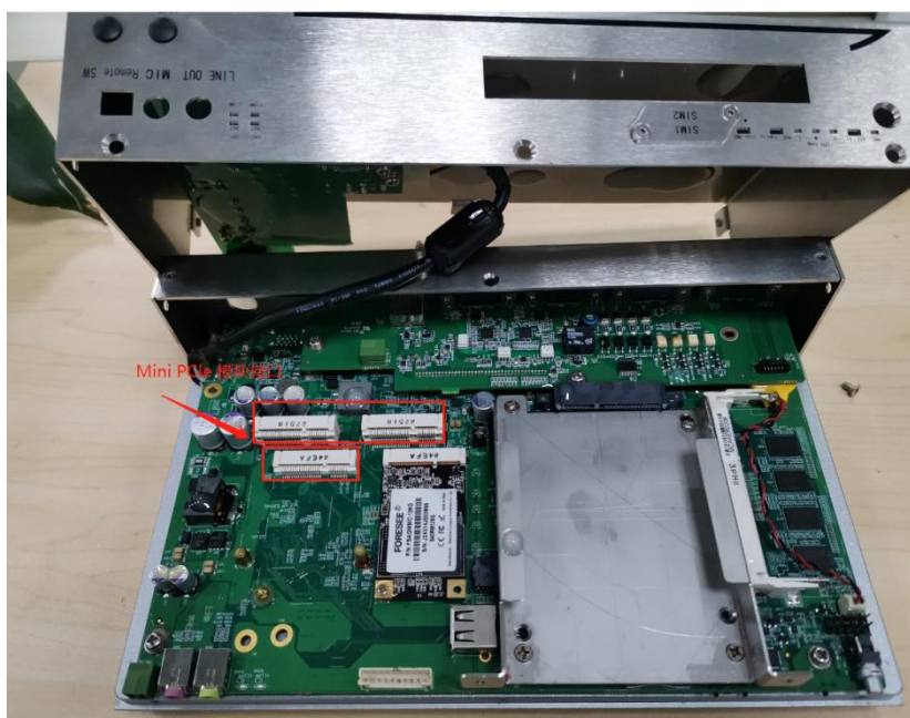
Picture 2.30: Mini PCIe installation (1)
